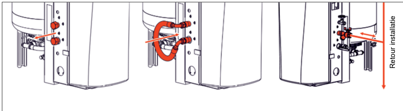
Afbeelding 14: Verbinding aansluitingen met de bypass-set en aansluiting op de retour
