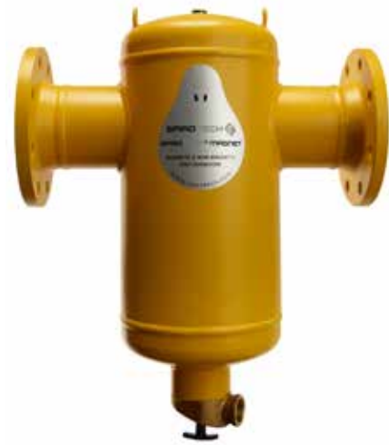
Om ook de kleinste vuildeeltjes (tot 5 µm) uit de installaties te verwijderen, heeft de HOMIJ-Bosman Combinatie een SpiroTrap vuilafscheider met magneet in de centrale retourleiding van de verwarmings- en koelinstallaties geplaatst.
